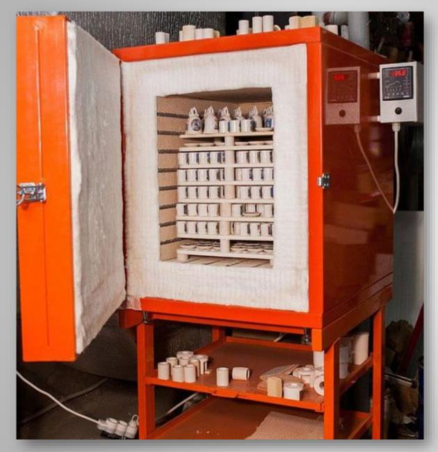
Следующий процесс изготовления керамического изделия - обжиг, в результате которого изделие приобретает прочность.
