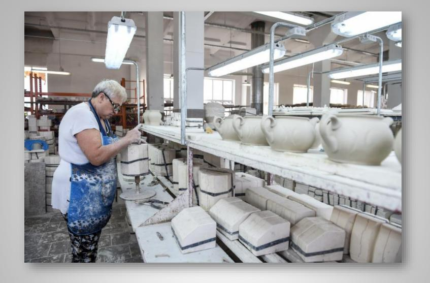
Затем изделие сушат в естественных условиях, и при достижении необходимой прочности переходят к следующей операции - оправке.
